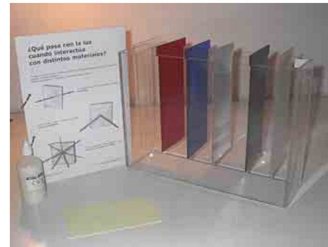
Un recipiente para experiencias ópticas; un set compuesto por 6 piezas de acrílico y una pieza de material luminiscente y un frasco dosificador con material dispersante.
