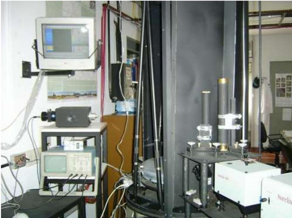
*Sistema LIDAR diseñado, desarrollado y construido en el CEILAP (CITEFA - CONICET) para el estudio de la troposfera desde los 300 m hasta los 13,5 km*
