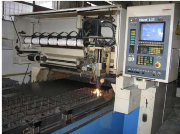
*Láser industrial de CO<sub>2</sub> para corte y perforado instalado en el CIOp en 1988.*
